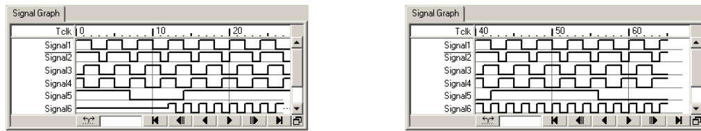
Slika 11 Pregled rezultata rada simulatora – vremenski oblici odabranih signala ( minimize mode )
