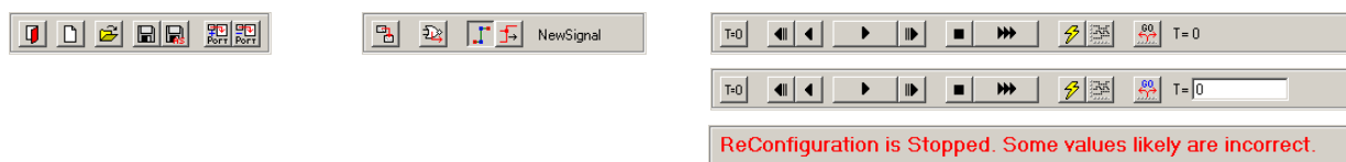
Slika 7 Grafički skup funkcija za rad sa datotekama ( File Toolbar ), za izbor režima rada grafičkog editora ( Editor Mode Toolbar ) i za rad sa funkcijama simulatora ( Simulation Toolbar )
